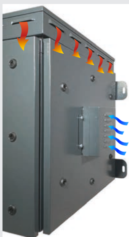
Rappresentazione del circolo dell'aria all'interno del Rack: pescaggio di aria fredda dal basso ed espulsione forzata di quella calda dall'alto.
